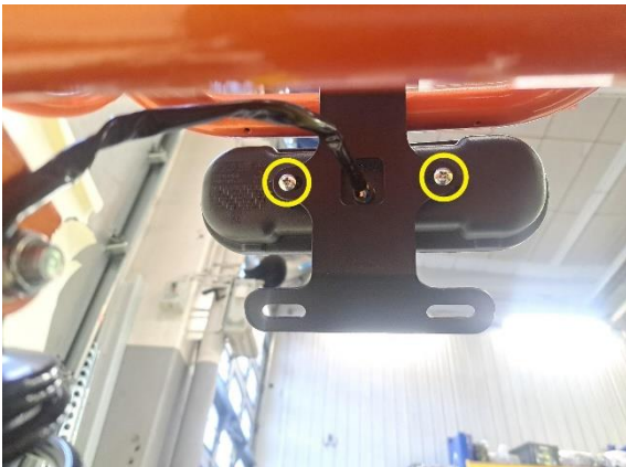
Irrota takavalon kiinnitysruuvit (ristipäämeisseli ph2).
