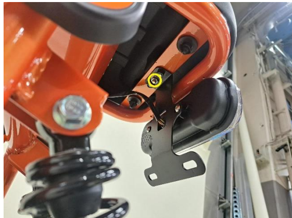
Irrota istuimen kiinnitysmutteri (kiintoavain 10 mm).
